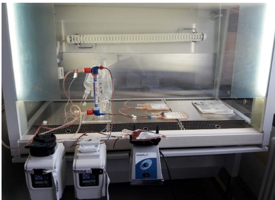
Рис. 8. Собранная в ламинаре установка для стерильного поведения процедуры проточного диализа для включения L-аспарагиназы в эритроциты. Суспензия эритроцитов прокачивается через диализный патрон перистальтическим насосом сверху вниз (при этом она постоянно перемешивается в исходном мешке с помощью специального шейкера). Гипоосмотический буфер прокачивается другим перистальтическим насосом в противоположном направлении (снизу вверх). Отработанные растворы и получающиеся диализованные эритроциты собираются в специальные контейнеры.
